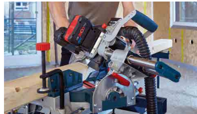
GCM 18V-216 BITURBO: 162 tagli in travi da costruzione in legno di abete (40 x 60 mm) con una sola carica della batteria ProCORE18V da 8.0 Ah [Test eseguito dall'Istituto di certificazione e testing autonomo DEKRA Testing and Certification GmbH per conto di Bosch Power Tools GmbH in data 02/2020 - report numero 3414140.02]
