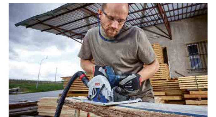
Sega circolare BITURBO GKS 18V-68GC - Prestazioni di taglio imbattibili: 458 tagli in travi di legno di abete 40 x 80 mm con una carica della batteria ProCORE18V da 8,0 Ah [Test eseguito dall'istituto di certificazione e testing autonomo DEKRA Testing and Certification GmbH per conto di Bosch Power Tools GmbH in data 02/2020 - report numero 341653200]
