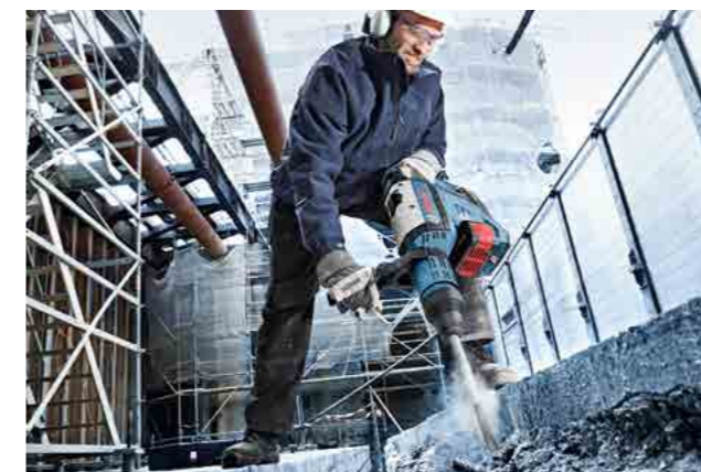
Martello GBH 18V-45 C: la distanza di foratura realizzabile con ogni carica della batteria ProCORE18V 12,0Ah con punta da 25 mm nel calcestruzzo C30/37 è di 427 cm - corrispondente a 14 fori da 30 cm di profondità. Test eseguito e certificato dall'istituto autonomo tedesco DEKRA - Dekra Testing and Certification GmbH per conto di Bosch Power Tools GmbH in data 02/2020 (numero report: 3414140.04).
